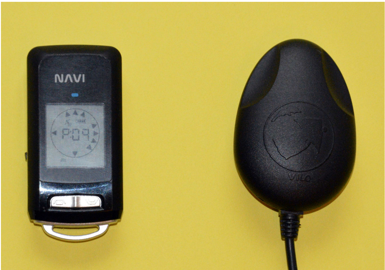
Abb. 2 Beispiele für GPS- Geräte: links ein Mini-Navigationsgerät und rechts eine GPS-Maus
