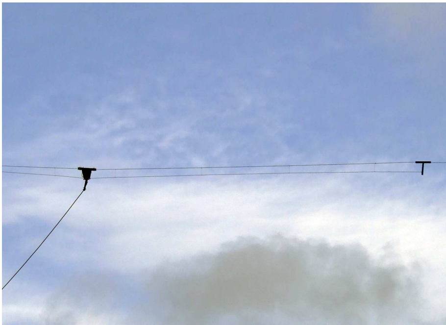
Abb. 5: Eine Antenne mit einem strahlungsgekoppelten Dipol für das 17 m-Band im Detail
