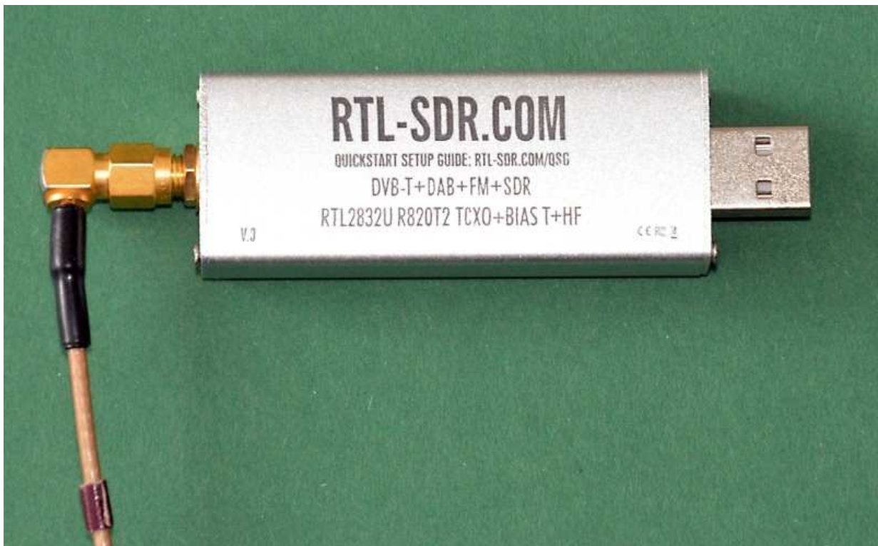
Bild 14: Stick mit dem RTL2832U R820T2-Chipsatz und einem TCXO sowie dem SMA-Anschlusskabel
