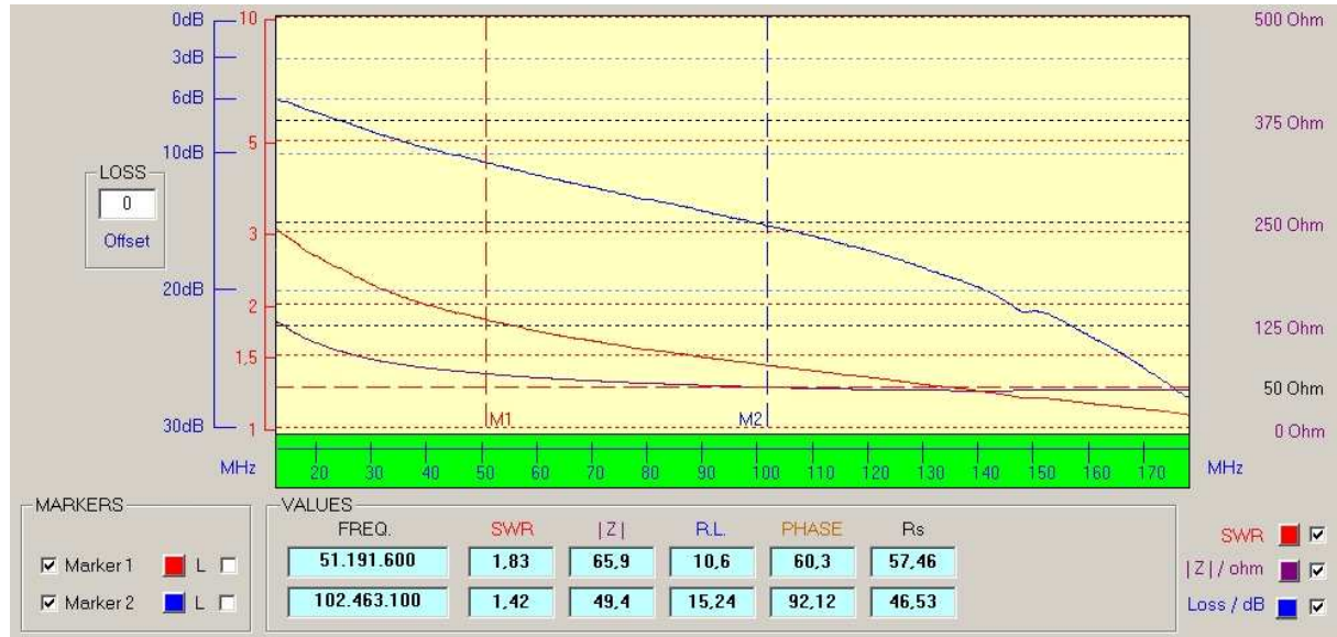
Bild1: Mit einem VNA von 13 bis 180 MHz ausgemessene Antennen-Eingang des Stick (siehe Text)
