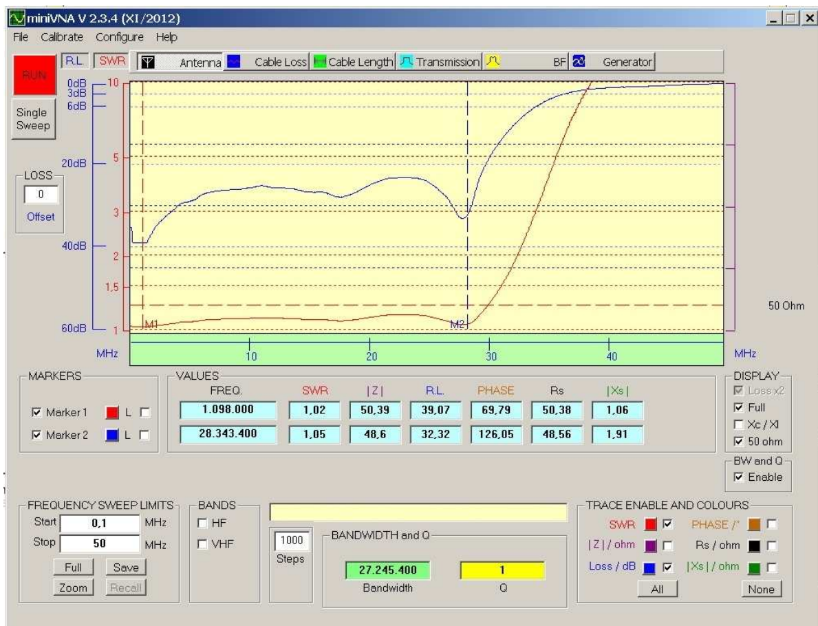
Bild 4: Mit einem VNA gemessene Kurven des Antenneneingangs <30 MHz bis zum Mischer
